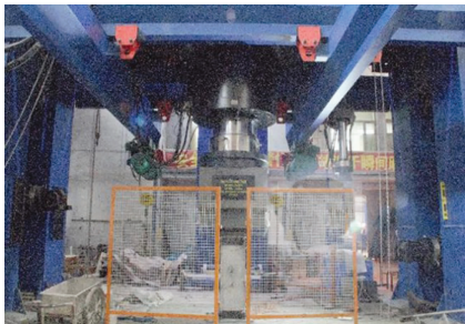
图 3 3 000 t 试验机加载装置 Fig. 3 Loading device of 3 000 t testing machine
